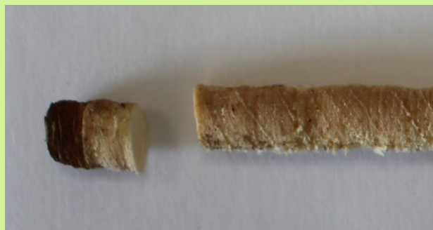
В) Керн будет пригоден для исследований только в том случае, если при отборе не был утерян маленький отрезок образца
